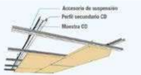
Ejemplo: Paneles Fibro-Kustik de 1200 x 600 mm con canto recto. Directamente fijado sobre perfilera metálica.
